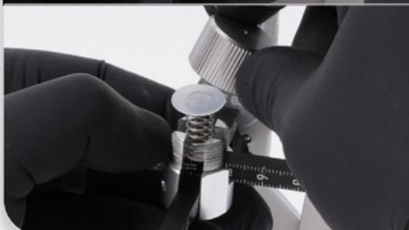
Setzen sie die Hutmutter von oben auf und drücken sie diese gerade nach unten.
