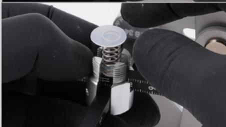
Legen sie die große Polyamidscheibe auf die Feder, sofern sich diese nicht schon in die Hutmutter befindet.
