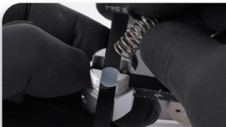
Auf die kleine Polyamidscheibe muss nun die Druckfeder aufgesetzt werden.
