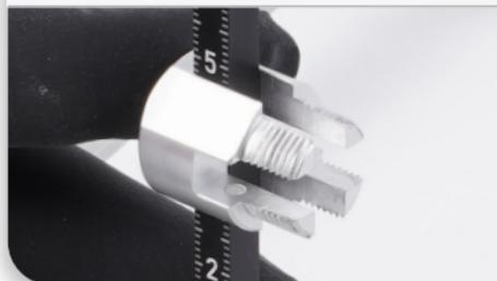
Setzen Sie Kreuzklemmfassung auf die Vertikalstange, so dass die abgeflachte Seite zu Ihnen zeigt, sie die Skala lesen können und rechts das Gewinde ist.
