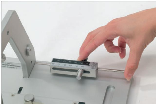
Ziehen sie den Messzeiger in Richtung Tastspitze, damit der Messkopf aus der Bodenplatte herausgehoben werden kann.
