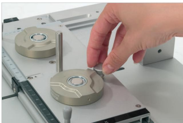
Die Sicherungsschraube für den beweglichen Messtisch wird herausgedreht...
