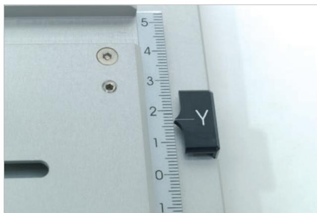
Der horizontale Y-Wert der Messung wird auf der rechten Skala abgelesen.
