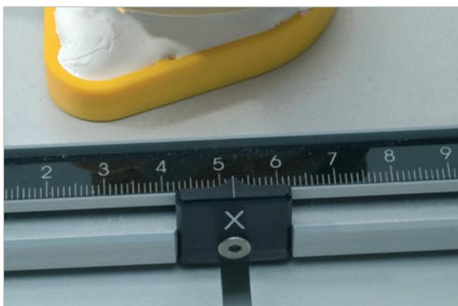
Der Messwert auf der X-Skala für die Randleiste sollte bei Verschiebung des Messtisches den gleichen Wert zum antagonistischen Arbeitshöcker zeigen.
