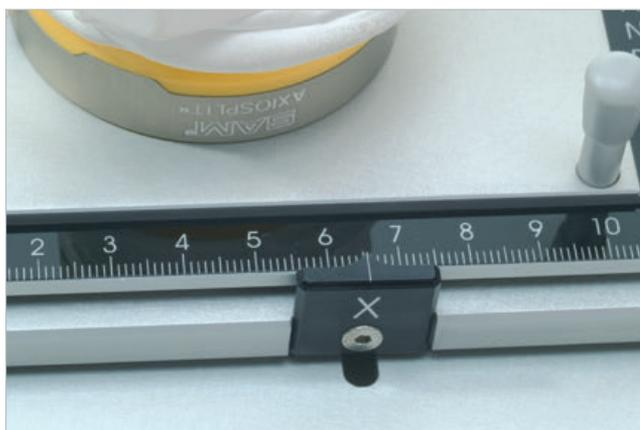
Der Messwert des Höckers auf der X-Skala sollte bei Verschiebung des Messtisches am antagonistischen Punkt den gleichen Wert zeigen.
