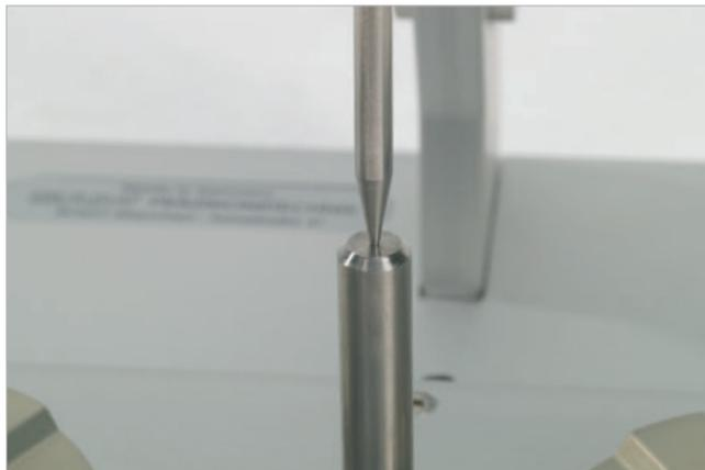
Der bewegliche Tisch wird so in Position gebracht, dass die Spitze des Messstiftes in der Vertiefung im Justierblock einrastet.
