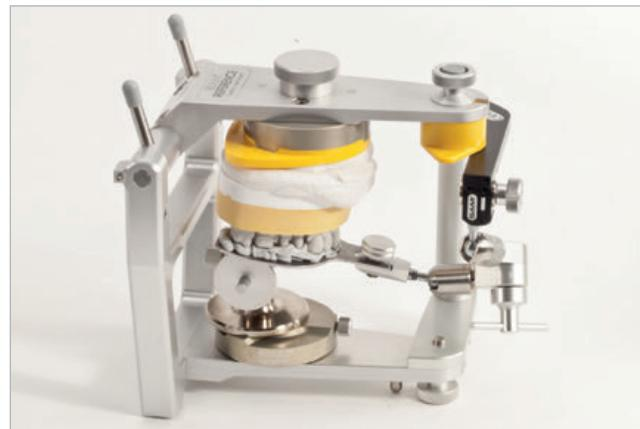
1.22 Das Montagegerät wird geöffnet und der Transferstand und die Bissgabel entfernt.
