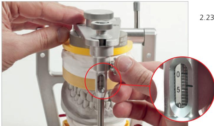
2.23 Nach der Entnahme des Zentrikregisters wird der Inzisalstift abgesenkt.
