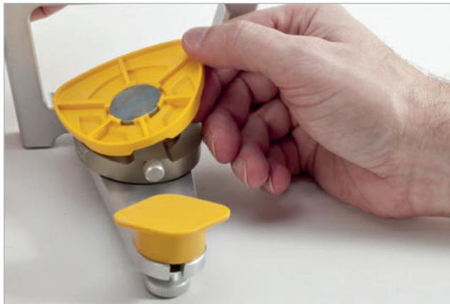
2.08 Die Montageplatte wird ins Unterteil eingesetzt
