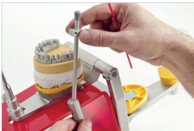
2.11 Der Modellhalter wird an der rechten Seite aufgesteckt und mit der Rändel-Schraube am unteren Ende fixiert.
