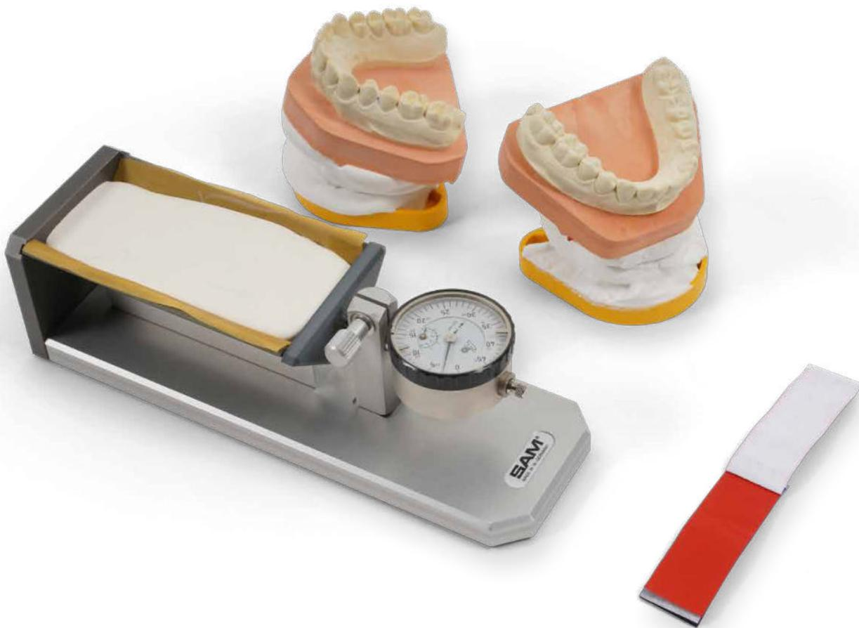
Die Notwendigkeit einer Gips- oder Einbettmassenkontrolle in Praxis und Labor ergibt sich aus den wechselnden Chargen der Hersteller, der örtlichen Wasserqualität und den individuellen Dosierungs- und Verarbeitungsmethoden. Das SAM Expansions- Messinstrument EMI wurde speziell zur Untersuchung der Expansion von Gipsen entwickelt, die Messgenauigkeit der
