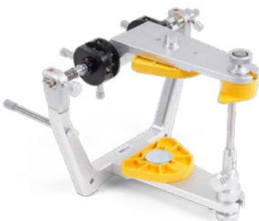
Spezialartikulator zur Herstellung von Aufbissbehelfen, auf Basis des Artikulators SAM 3, mit Kreuztischführungen statt Kondylargehäusen, mit präziser Einstellmöglichkeit dank Nonius-Anzeige, Lateralverstellung zur linearen Verlagerung der Kondylenpositionen.
